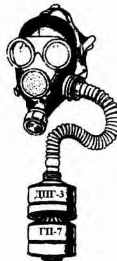
Рис. 2.11. Противогаз ГП-7 в комплекте с допатроном ДПГ-3
