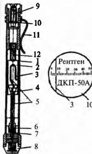
Рис. 18.3. Дозиметр карманный прямопоказывающий ДКП-50А
